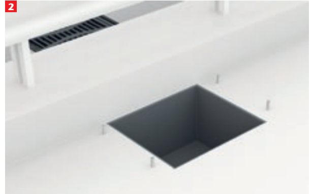
2 Setzen von Stehbolzen (vorzugsweise Klebeanker)
