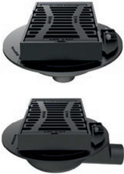
ACO Brückenablauf Multitop HSD-2 Kennmaß 300 x 500 aus Gusseisen Klasse D 400 nach DIN EN 124 Artikel entspricht der Richtzeichnung Was 1
