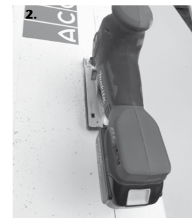
Szűrőfűrészsel vágja le a magasítóelemet a megfelelő hosszra. Ha szükséges, először távolítsa el a merevítő acélprofilokat.
