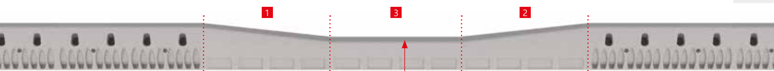
Ferde süllyesztett elem lejtéssel (1 darab)
