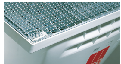
Négyzethálós rács (30x10), gyalogos terhelhetőségű 1,5kN-ig, személygépkocsi terhelhetőségű, 9kN-ig ráparkolható.
