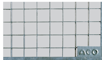
Négyzethálós rács, hálóméret 30 x 30 mm 1,5kN-ig gyalogos terhelhetőségű
