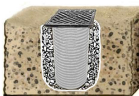
3. Geotextíliával (tartozék) bur- kolt szikkasztó akna elhelye- zése, pozícionálása, majd körülfutó kavicsal való feltöl- tése
