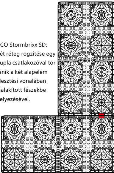
ACO Stormbrixx SD: Két csatlakozó egymásba illesztése adja a rögzítési pontot a két réteg között.
