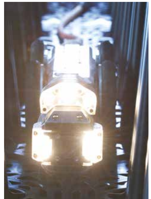
Önjáró kamera a rendszerben
