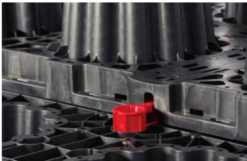
ACO Stormbrixx HD: Két csatlakozó egymásba dugásával biztosíthatjuk két réteg elcsúszás elleni védelmét.
