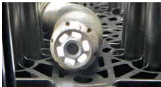
Kamera és nagynyomású mosófej bevezetése
