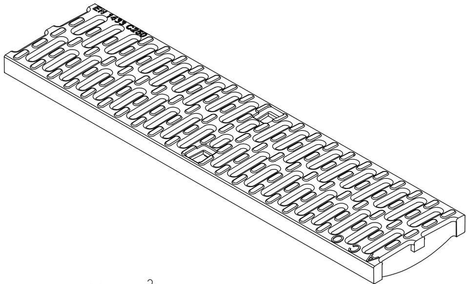
Einlaufquerschnitt: 284 cm<sup>2</sup> / m
