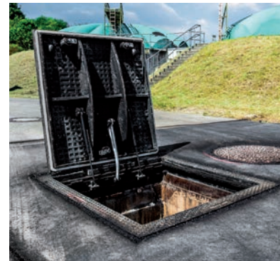
Gussabdeckung tagwasserdicht mit Öffnungshilfe, Belastungsklasse D400, lichte Weite 1000 x 1000 mm, München
