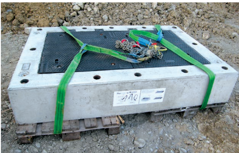
Kabelschachtabdeckung tagwasserdicht als Fertigteil mit höhenverstellbarem Stahlbetonrahmen, Belastungsklasse D400, Biel/Schweiz
