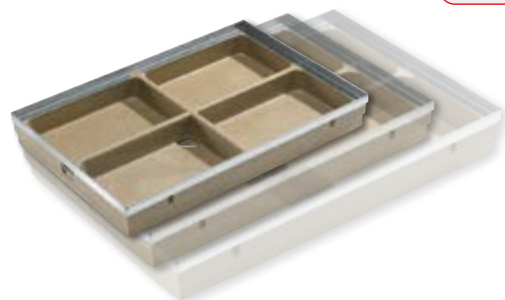
Vario lábtörőtálca minden Vario ráccsal kompatibilis, polimerbetonból, belső merevítőbordákkal, DN100 lefolyócső-csatlakozóval, integrált horganyzott acél élvédelem, építési magasság 8 cm
