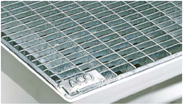
Hálós rács, 30 x 10 mm, terhelés maximum 1,5 kN, gépkocsiterhelés esetén a kerékkerhelés maximum 9 kN
