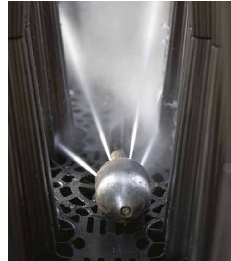
Nagynyomású mosófej. Bármilyen szennyeződés, ami a rendszerbe kerülhet, egyszerűen eltávolítható a tisztítóegység alkalmazásával.
