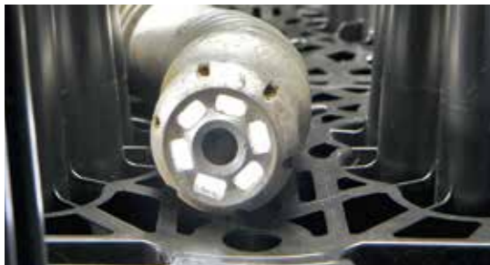
Kamera és nagynyomású mosófej bevezetése
