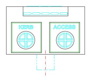
Benennung: ACO DRAIN KerbDrain Typ KD 305 Revisionselement, monolithisch einteilig, L= 0,5 m
