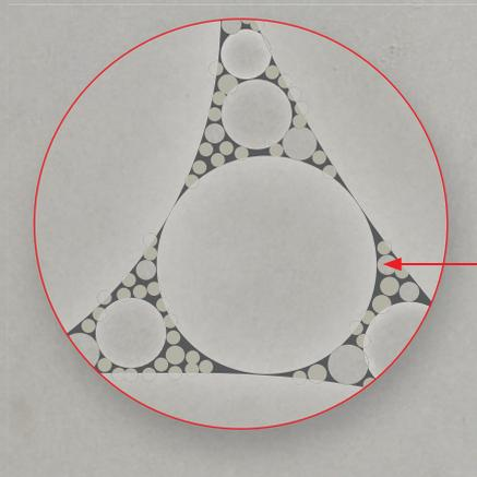
■ rein mineralische Feinstfüllstoffe mit optimaler Packungsdichte
