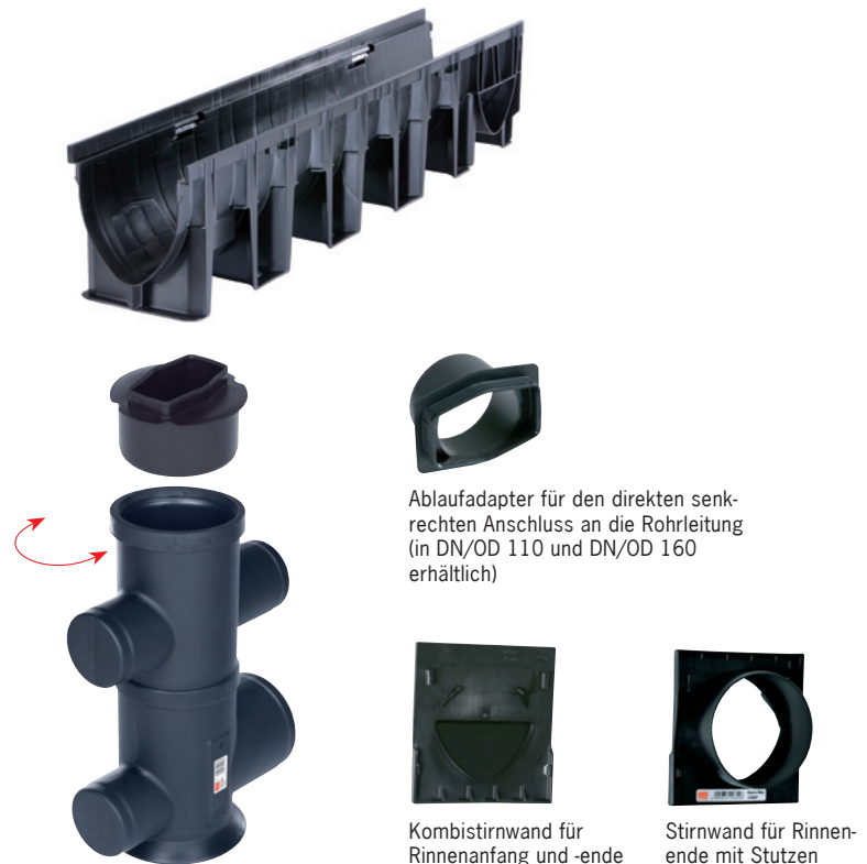
Ablaufschacht mit Schmutzfangeimer und Ablaufadapter zum Anschließen senkrecht unterhalb der Rinne, seitliche Abgänge DN/OD 110 oder DN/OD 160
