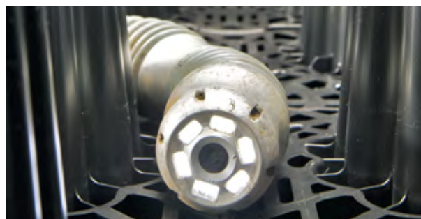
Schiebekamera, Reinigungsgerät mit Spülkopf
