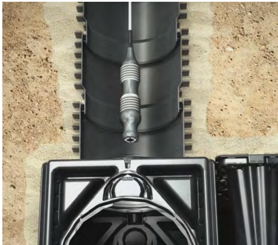
Die Inspektionskamera wird über ACO Stormbrixx Oberteile und Schachttunter-/zwischensteile vertikal in das Rigolensystem eingebracht
