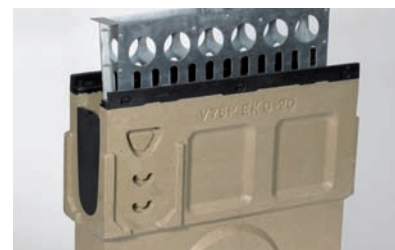
ACO DRAIN® Powerdrain Einlaufkasten V 75 P mit Schlammeimer stahlverzinkt, mit abschneidbarer Anschlusschablone, mit integrierter Lippenlabirinthdichtung (wahlweise mit DN/OD 110 oder 160)
