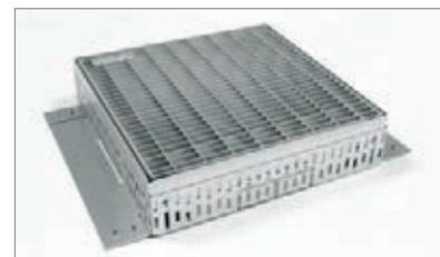
Nach dem Einlegen des Rostes werden die Niederhalteklammern, mit der mitgelieferten M5 Schraube, durch die Masche mit dem Aufsatz verschraubt. Die Verriegelung der Aufsätze in fixer Bauhöhe und der Aufstockelemente funktioniert in gleicher Weise.
