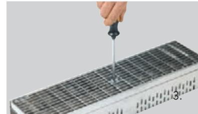
■ Bild 3: Die Rostverriegelung ist ganz einfach mit einem Schlitzschraubendreher, durch eine viertel Drehung nach links oder rechts, zu betätigen.
