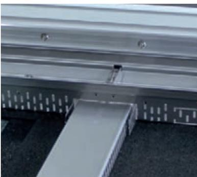
Einschieben des Stichkanals in die Rinne. Zu Empfehlen sind min. 2 Stichkanäle mit einer Länge von 50 cm pro Meter Rinne
