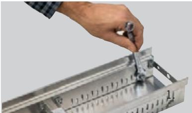
■ Bild 1–2: Durch Lockern der Schloschraube SW 13 mm lässt sich die Höhe stufenlos einstellen und anschließend fixieren.
