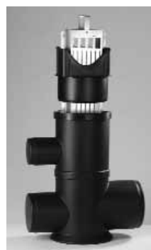
X 200 típusú zomp-akna, antracit színű műanyagból élvédelemmel, szennyfogó vödörrel, DN 200 adapterrel, kifolyás DN 200
