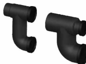
Búzzár műanyagból, bekötőaknához, választható kicsatlakozással DN 100 vagy DN 150 méretben, gumitömítéssel
